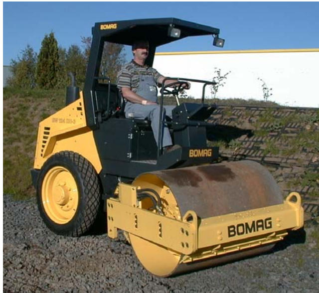
Bild 6: Mit dem 2-stufigen Vibrationssystem der kleinen Walzenzüge werden unterschiedlichste Einbaumaterialien, vom Sand bis zum bindigen Lehm, effektiv verdichtet.
