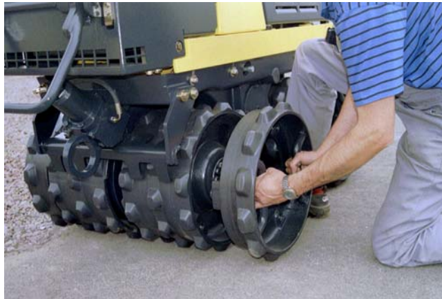
Bild 4: Mit der einfach zu montierenden Verbreiterung der Bandagen wird die Arbeitsbreite des BOMAG Mehrzweckverdichters BMP 851 von 610 mm auf 850 mm vergrößert.
