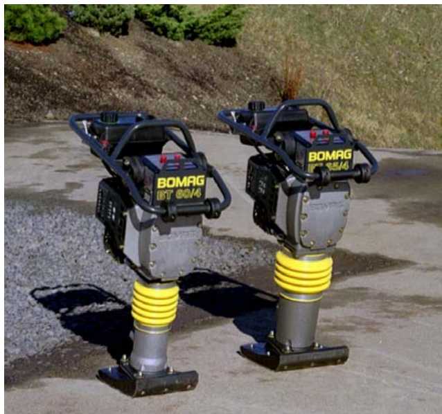
Bild 1: Die neuen BOMAG Viertaktstamper BT 60/4 und BT 65/4 zeichnen sich besonders durch das hervorragende Vormarschverhalten und die hohe Schlagkraft aus.
