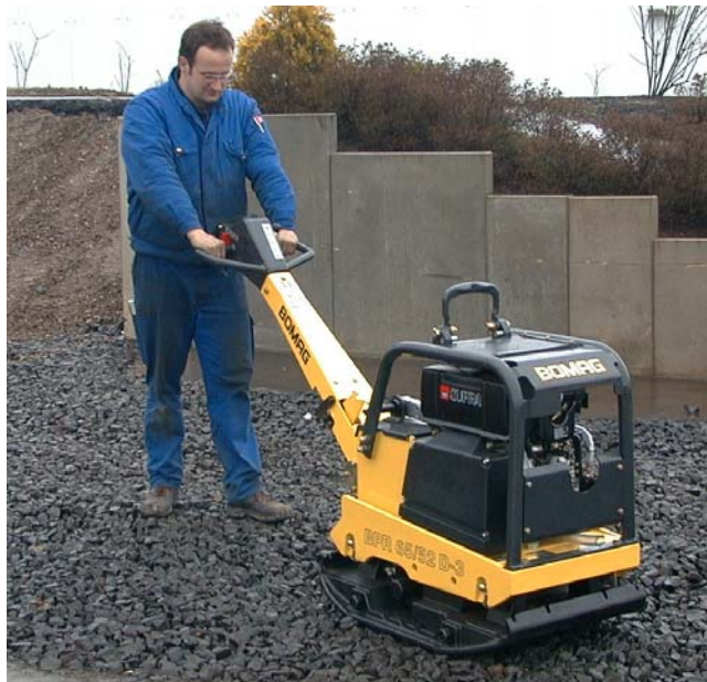
Bild 3: Wechsel der Fahrtrichtung: Kein Reissen und Ziehen am Hebel; nur Antippen und die Maschine hält automatisch die gewählte Fahrtrichtung und Geschwindigkeit – Standard bei fast allen Modellen oberhalb 500 kg Betriebsgewicht.
