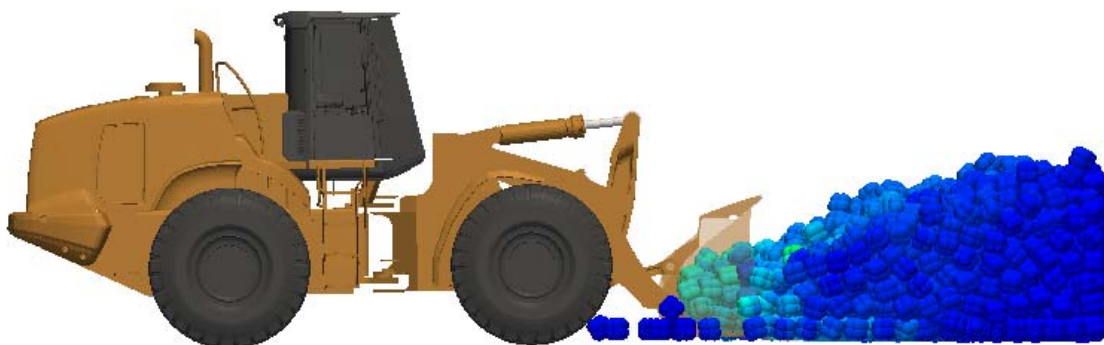
Bild 6: Visualisierung der Simulationsergebnisse des Radladers beim Befüllen der Schaufel mit Quadern
