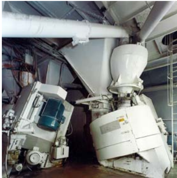
Bild 1: Intensivmischer Typ R19 für Werkbeton
