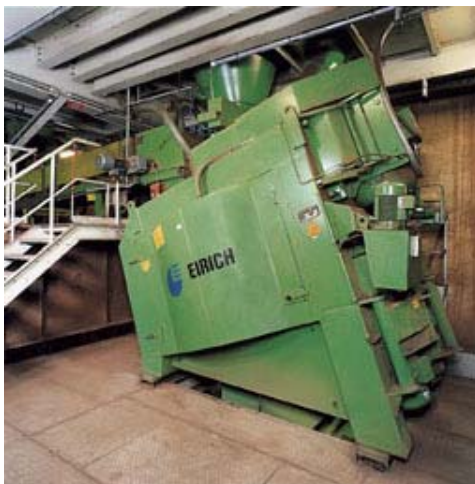
Bild 5: Intensivmischer zur Aufbereitung von Stahlwerksabfällen
