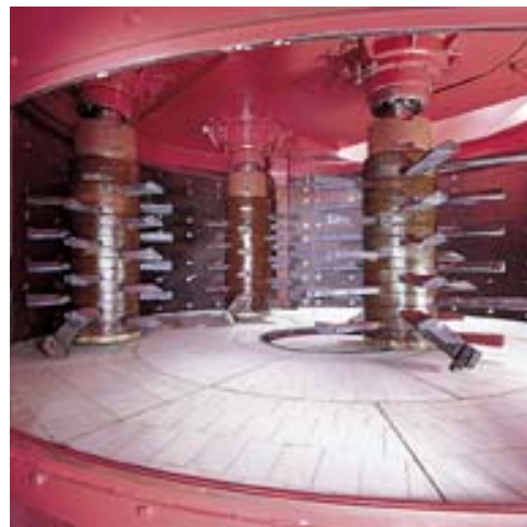
Bild 6: Mischerinnenraum mit 3 Wirblern und Verschleißschutz
